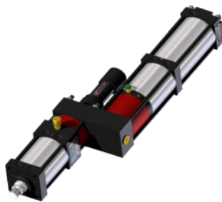
Unité de Puissance forme Z Limitation de Course Totale Effort à 6 bars: de 20 à 150 kN Course Totale: de 50 à 200 mm Course Travail: de 6 à 12 mm
