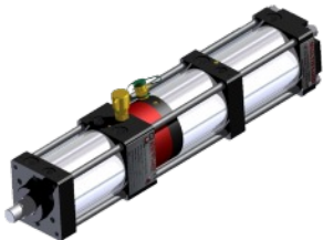
Unité de Puissance Standard Effort à 6 bars: de 10 à 500 kN Course Totale: de 32 à 250 mm Course Travail: de 6 à 15 mm
