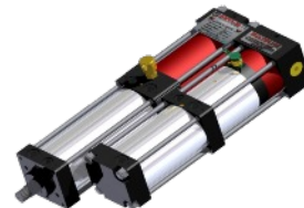
Unité de Puissance forme K (Parallèle court) Effort à 6 bars: de 20 à 140 kN Course Totale: de 50 à 200 mm Course Travail: de 5 à 12 mm
