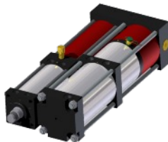
Unité de Puissance Parallèle Effort à 6 bars: de 40 à 300 kN Course Totale: de 100 à 500 mm Course Travail: de 10 à 25 mm
