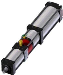
Unité de Puissance type H (High Course) Effort à 6 bars: de 20 à 140 kN Course Totale: de 50 à 200 mm Course Travail: de 14 à 45 mm
